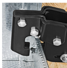
Пуансон инструмента продавливается через профили
